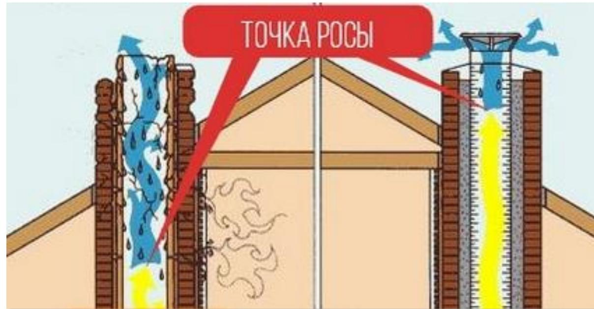
Известными способами, позволяющими предотвратить образование сосулек (наледи) на поверхности дымовой трубы, являются повышение температуры дымовых газов до температуры значительно выше точки росы с одновременным увеличением их скорости. При этом происходит улучшение экологической обстановки в районе расположения ТЭЦ.
