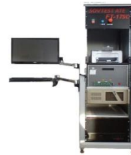
Тестер полупроводниковых компонентов FT-17SC
